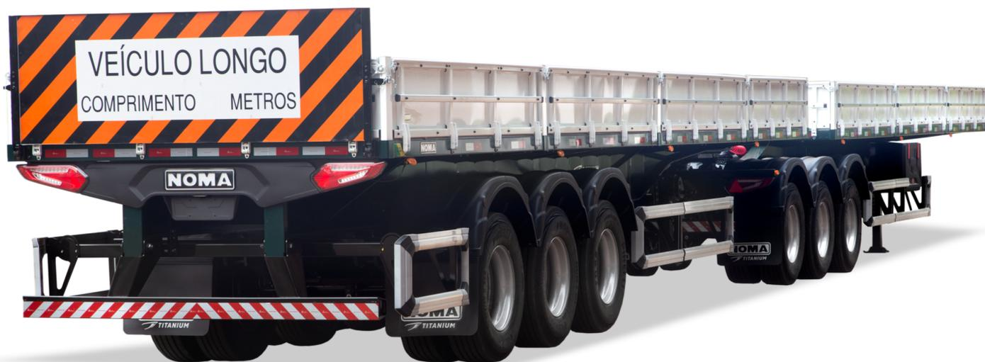
Acomodação no chassi. Ancoragem segura. Berço reforçado. Tampas do berço. Maior segurança na amarração de carga em função dos fixadores apropriados para o transporte de bobinas. Produto testado e validado pela ACERLOR MITAL.
