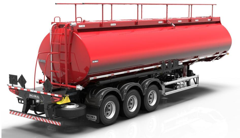
Formato ovalado com centro de gravidade do tanque mais baixo. Em aço carbono conformado com maior resistência e menor altura permitindo acesso a áreas de altura restrita, com menor raio de giro as manobras em áreas urbanas são facilitadas. Com perfil longitudinal ao longo da caixa de carga a proteção das bocas de visita são maiores. Suporte da Mão de Amigo parafusado na mesa, com melhor organização da fiação e facilidade de manutenção.
